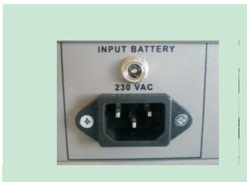
**Input battery** - Konektor za priključak eksternog napajanja (baterija 12V,7,2Ah).
